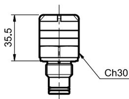
Diese Anzeige misst den Differentialdruck zwischen dem Filtereingang und -ausgang.
