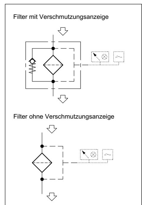
**HINWEIS 2: Die Filtergröße soll so bemessen sein, dass der Strömungsverlust bei Nennvolumenstrom niedriger als 1,2 bar ist.**
