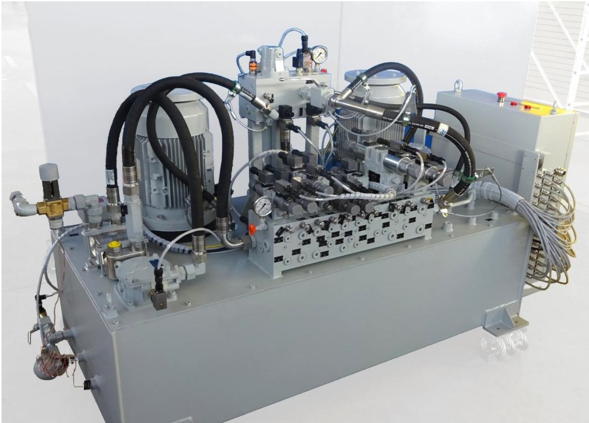
**FORNITURA:** Centrale per il comando del verricello per il rilascio in mare di sistema antisommersibile sonar
