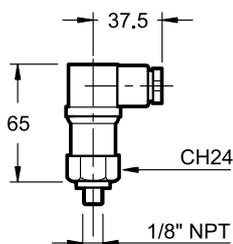
Questo tipo di indicatore è un pressostato SPDT, sensibile alla pressione in ingresso al filtro, che interviene modificando lo stato di un contatto elettrico al raggiungimento del limite di intasamento dell'elemento filtrante.
