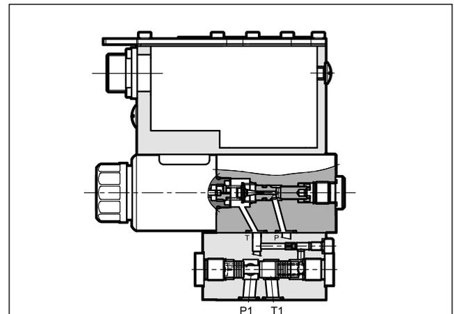
— PRE3G\*-Ventil ist ein vorgesteuertes Proportional-Druckbegrenzungsventil mit integrierter Elektronik, dessen Anschlussbild der Norm ISO 4401 entspricht.
