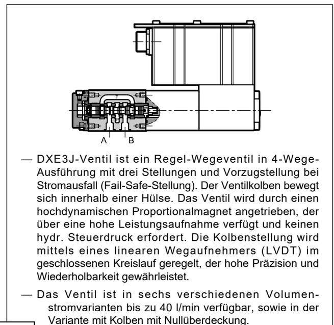
— Eine für den Einsatz in explosionsgefährdeten Bereichen geeignete Ausführung - gemäß ATEX 2014/34/EU II 3GD - ist ebenfalls verfügbar.
