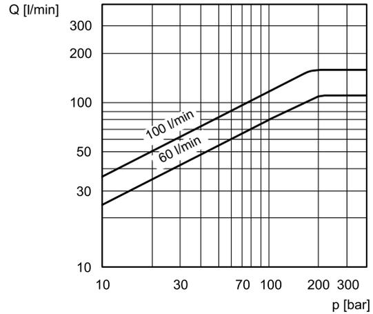
Das Diagramm zeigt den max. gesteuerten Volumenstrom in Abhängigkeit des  $\Delta p$  zwischen den Anschlüssen P und T.
