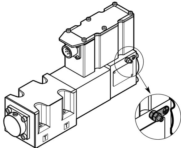
Der Erdungspunkt muss immer über eine geeignete leitfähige Leitung mit dem allgemeinen Erdungssystem verdrahtet werden.
