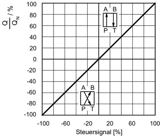
Die Kennlinien stellen die Volumenstromregelung bei einem konstanten  $\Delta p = 70$  bar P-T in Abhängigkeit des Referenzsignals dar.
