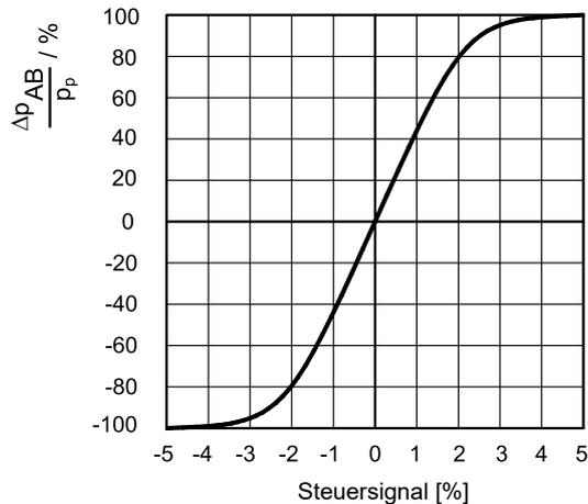
Das Diagramm zeigt die Ventildruckverstärkung, die als % des Verhältnisses der Druckdifferenz in den Anschlüssen A und B ( $\Delta p_{AB}$ ) zum Druck auf der Leitung P - je nach dem angelegten Referenzsignal - ermittelt wird.
