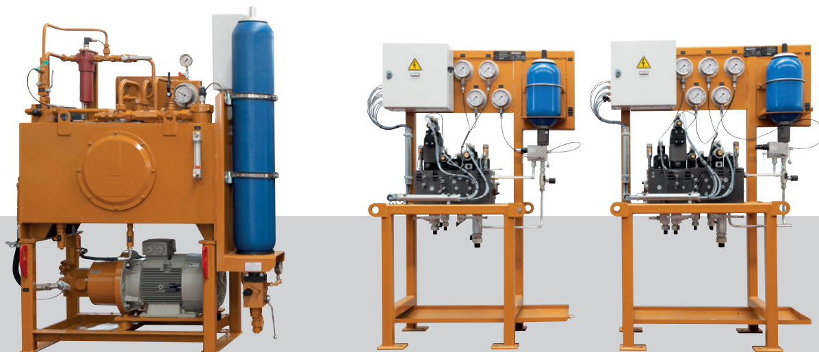
Siderurgia - banchi controllo segmenti di colata
