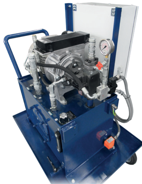
Testing - centrale per movimentazione servo cilindri per prove dinamiche
