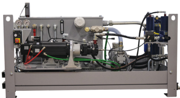
Centrale idraulica per punzonatrice con servo pompa
