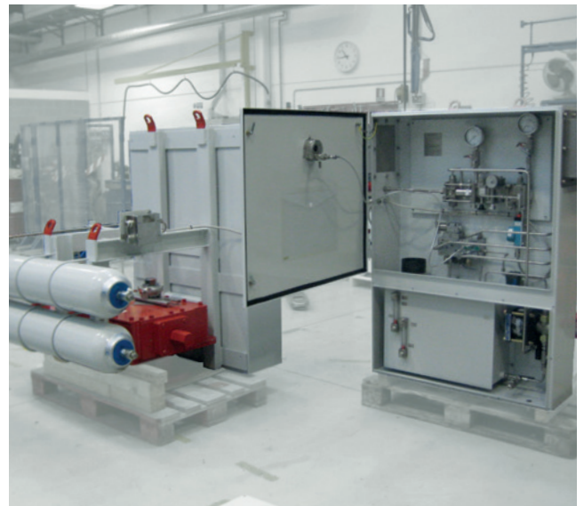
Centralina per il comando dell'attuatore e delle valvole sezionatrici per oleodotto
