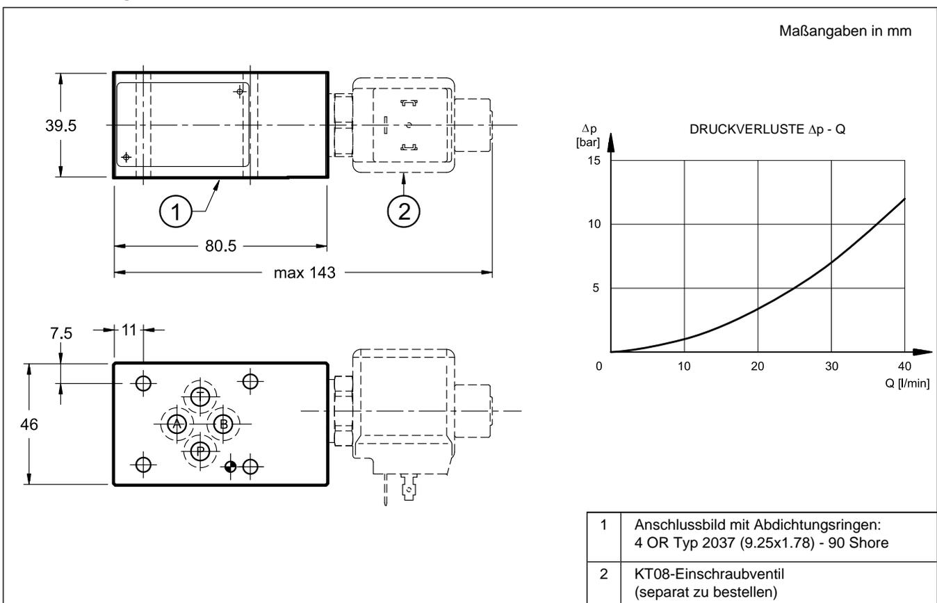
20.4 - Abmessungen und Anschlüsse KTM3-D, KTM3-RD und KTM3-SB
