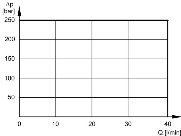
Die Messungen werden gemäß der Norm ISO 6403 ausgeführt, wo die Versorgungsspannung 90% der Nennspannung ist und die Magnetspulen die Ausgleichtemperatur erreichen.
