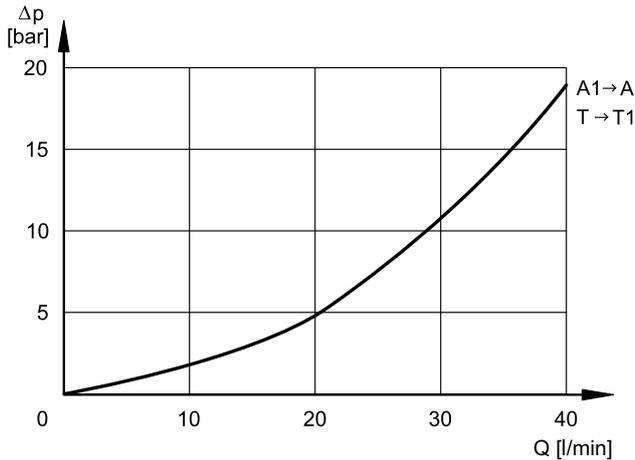
Die in dem Diagramm dargestellten Werte beziehen sich auf den Volumenstrom durch das 2-Wege-Elektromagnetventil im sogn. "Schnellgang". Die Werte gelten sowohl für die normal offene Ausführung A als auch für die normal geschlossene Ausführung C.
